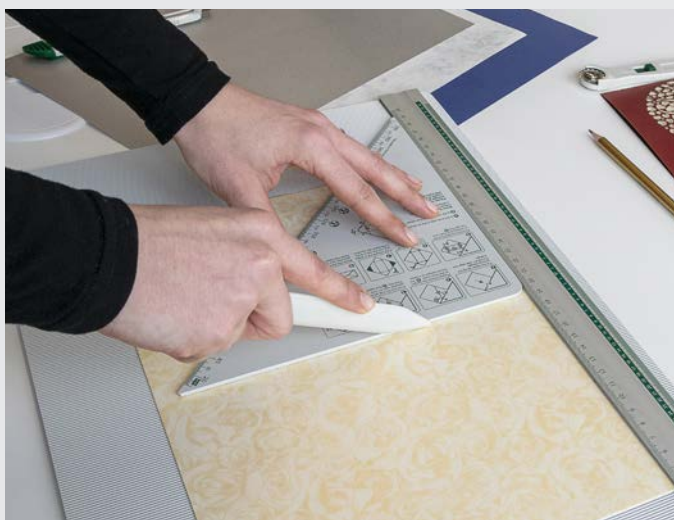
Prowadzenie linii bigowania wzdłuż rowków wytłoczonych na jednej ze stron tablicy zapewnia równe zgięcie papieru.
